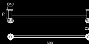
16 004L ● ● ● ● Toallero barra 60 cm. Towel bar large 60 cm. Porte-serviette 60 cm. Handtuchstange 60 cm. Держатель для полотенца большой 60 cm.
